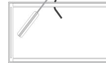
Die Deckenschiene an der Decke fixieren, den Leuchtenkörper aufsetzen und mittels der zwei Schieber fixieren. Anschließend weiter verfahren wie bei der Wandmontage (Punkt 4 + 5).
