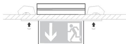
Schrauben mit den beigefügten Kunststoffkappen abdecken.
